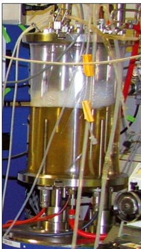
Die Zellen werden in der Innenkammer kultiviert, das Medium der Außenkammer lässt sich nach Bedarf erneuern oder austauschen.
